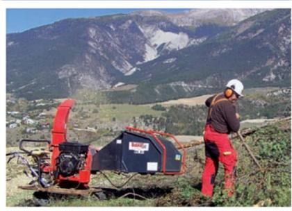
Pour la réalisation de ce chantier, un **nouvel engin adapté aux travaux d'entretien en terrain difficile**, a été mis au point par l'entrepreneur, M. Jacques David : c'est un broyeur Bugnot monté sur une petite chenillette, suffisamment étroite et maniable pour pouvoir emprunter les sentiers existants. Sur le chantier de Mont-Dauphin, l'utilisation de ce matériel
