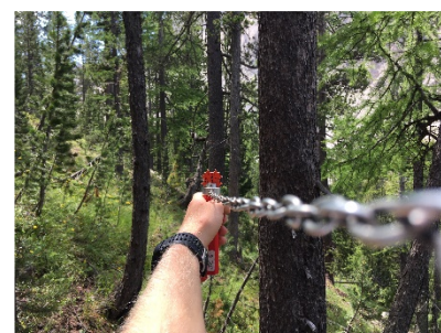
Figure 5 : Utilisation du relascope pour estimer la surface terrière
