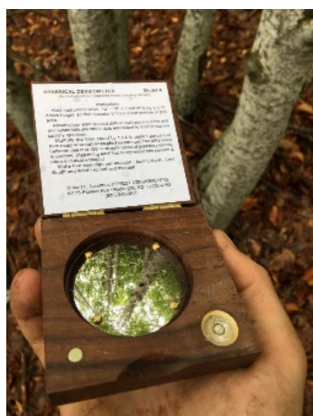
Figure 6 : Densiomètre convexe utilisé en hêtraie
