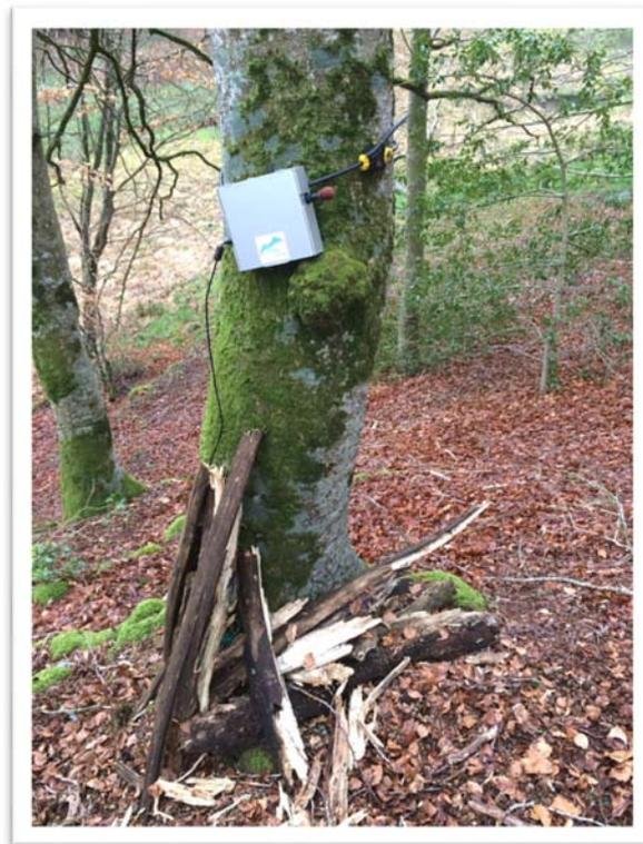
*Boîtier de l'enregistreur muni d'un micro fixé sur un hêtre (Photo T. Darnis / ONF)*
