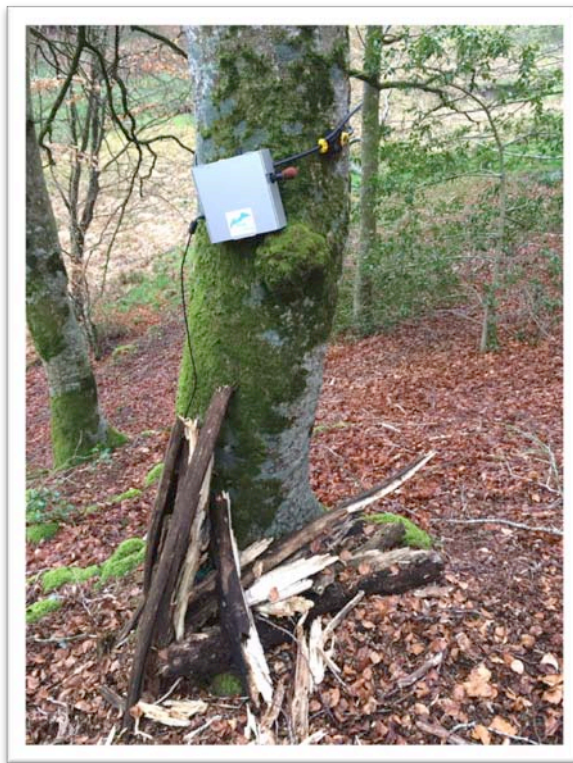
Boîtier d'enregistreur SM2Bat+ muni d'un micro fixé sur un hêtre (Photo T. Darnis / ONF)
